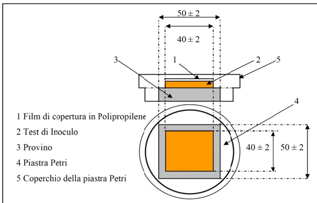
Figura 1 – Caratteristiche standard del campione da analizzare
